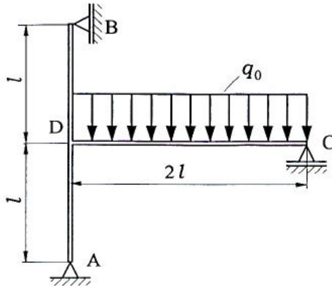
Der skizzierte Rahmenträger ist in den Auflagern A (Festlager), B und C (Rollenlager) gelagert und wird durch die konstante Streckenlast  $q_0$  zwischen dem Verzweigungspunkt D und dem Lager C belastet.
