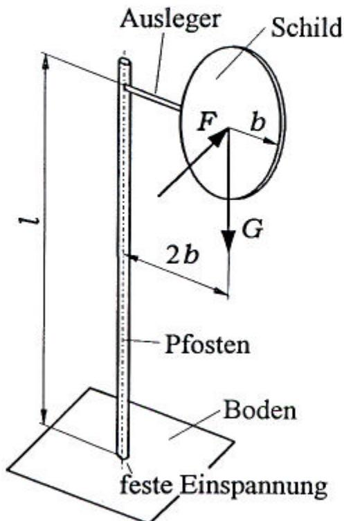
Ein Pfosten mit Rohrquerschnitt (Außendurchmesser  $D_a$ , Innendurchmesser  $D_i$ ) ist im Boden fest eingelassen (feste Einspannung).
