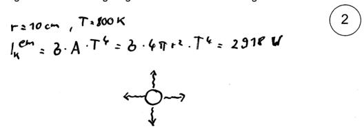
b) Wie groß ist die Aufnahme von elektrischer Heizleistung, wenn die Umgebung der Kugel eine Temperatur von 300 K hat?
